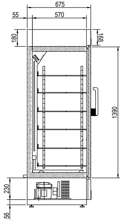
Lüftungsschlitze an der Maschinenraumblende dürfen nicht verdeckt werden.
